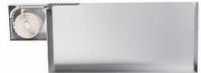
Unterwasser-Rollo: obere Nische - bewegliche obere Abdeckung
