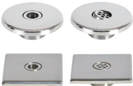
Dysza przeznaczona do basenów foliowych oraz betonowych. Dysza wykonana jest ze stali AISI 316. Cechą charakterystyczną jest jej niski profil oraz brak wystającej kulki powyżej maskownicy. Do dyszy o wysokości 35 mm zostały zaprojektowane specjalne przepusty o numerach 30354 /30355/30362/30363. Zasys powietrza odbywa się poprzez tuleje ze zwężką Venturiego. Im większa prędkość wody tym większa prędkość zasysania powietrza.
