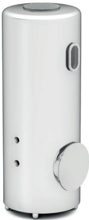
Zbiornik boczny filtra wykonany ze stali nierdzewnej AISI 316. Przeznaczony jest do basenów publicznych. Może pracować jako filtr ze złożem, piaskiem kwarcowym lub z wielowarstwowym złożem zawierającym hydroantracyt. Ciśnienie robocze: 0.5-2.0 bar . Ciśnienie max: 3.0 bar. Temperatura pracy od 1-55 °C. Możliwość zamówienia zbiorników do słonej wody (solanki).
