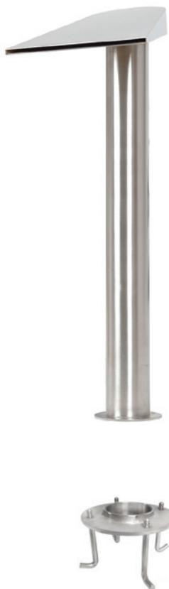
Wylewki wykonane ze stali nierdzewnej AISI 316. Podstawa montażowa oraz wylewka sprzedawane są osobno. Szerokość wylewki 350 mm - wydajność pompy 35 m<sup>3</sup>/h, szerokość wylewki 500mm - wydajność pompy 50 m<sup>3</sup>/h.
