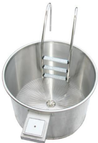
Zagębiona niecka basenowa o kształcie okręgu wykonana jest ze stali nierdzewnej AISI 316 i szczelecznie zespawana od wewnętrznej strony z samonośnie wykonanych blach ściennych. Produkt posiada antypoślizgową podłogę. W podstawowym wyposażeniu znajduje się skimmer z przyłączeniem 2". Baseny schładzające Lepsod stworzone dla hoteli, kompleksów z saunami i ośrodków spa.
