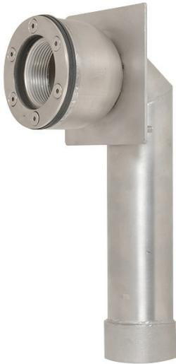
Przepusty do masażu do basenów foliowych lub płytkowych wykonane ze stali nierdzewnej AISI 316. Zakończone obustronnie takim samym gwintem wewnętrznym. W zestawie z kołnierzem zapobiegającym przesiąkaniu oraz z uszczelkami. Przystosowany do montażu w szalunku do basenów foliowych.
