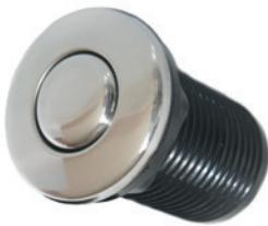
Przycisk pneumatyczny o klasie szczelności IP67, front wykonany ze stali nierdzewnej AISI 316. Przycisk pneumatyczny stosowany jest ze względów bezpieczeństwa tak aby wyeliminować konieczność stosowania przycisków elektrycznych. Oferujemy przyciski o powierzchni matowej oraz polerowanej. Otwór montażowy 34,2 mm.
