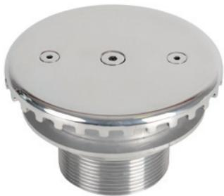
Dysza napływova denna ze specjalnym systemem zamykania oraz regulacji. Dzięki możliwości zamykania, orurowanie w basenie zewnętrznym jest chronione w sezonie zimowym. Regulacja dyszy pozwala na kontrolowanie natężenia dopływu wody do basenu. Dysza do foli posiada dodatkowo dwie uszczelki oraz pierścień dociskowy wraz z kompletem śrub, dzięki czemu jest całkowicie bezpieczna i nie rozerwie folii. Przepływ 10,5 m<sup>3</sup>/h.
