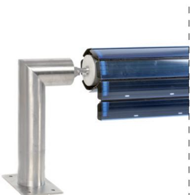
Roleta nadwodna stosowana nad powierzchnią basenu. Maksymalny wymiar basenu dla rolety to 12x6 m. Roleta wyposażona w silnik rurowy 240 Nm oraz 2 podpory okrągłe szlifowane wykonane ze sali 316 L. Dodatkowo zestaw wyposażony w przełącznik kluczykowy manualny.
