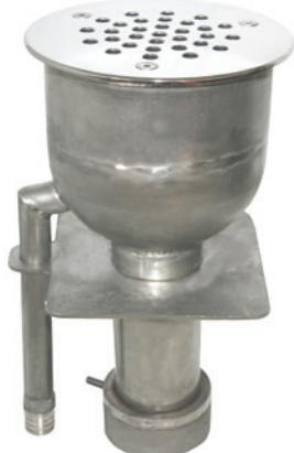
Dysza do masażu wodno-powietrznego wykonana ze stali nierdzewnej AISI 316 w zestawie z przepustem. Zasys powietrza w przepuscie odbywa się poprzez tuleje ze zwężką Venturiego. W zestawie z kołnierzem zapobiegającym przesiąkaniu, z pokrywą dyszy tloczonej oraz z uszczelkami. Dysza przystosowana jest do montażu do basenów foliowych oraz płytkowych. Przepływ: 20 m<sup>3</sup>/h.
