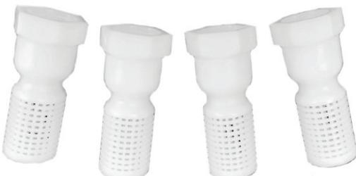
Kosz ssawny 3/8" wyposażony jest w zawór zwrotny pracujący w maksymalnym ciśnieniu roboczym 10 bar. Może być montowany w dowolnej pozycji. Idealny do montowania na końcach odcinków ssawnych masaży powietrznych.
